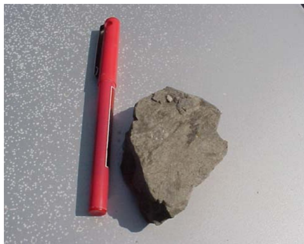
Figura 4. Frammento di Marna a Pteropodi prelevata presso il settore di valle della frana, ad una profondità di 16÷16.5 m dal piano di campagna, in corrispondenza di una zona di taglio.
