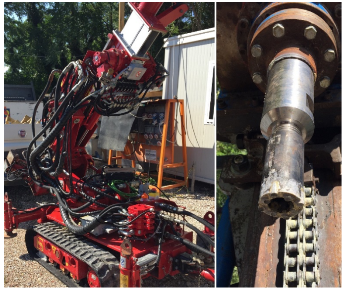
Figura 3 – Esempio di macchina perforatrice e particolare del martello a fondo foro.
