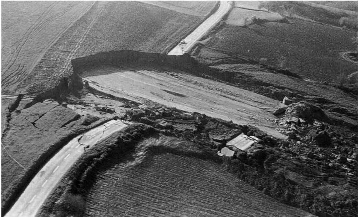
Fig. 5 – Frana planare nelle Langhe su superficie a bassissimo angolo di inclinazione (da: Veniale et al., 2002).
